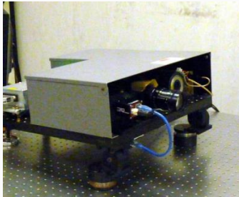
APPARATO COMPATTO SPERIMENTALE CONTENETE TUTTI I COMPONENTI (DIMENSIONI 50x50 cm)
